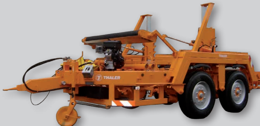
TCT 10 abgebildet mit doppeltem Gummiwalzenantrieb TCT 10 with drum drive with double friction roller
